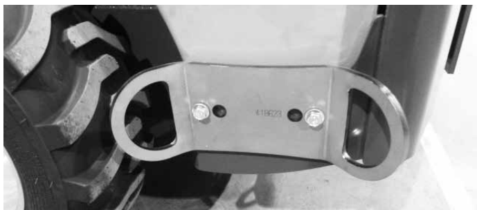
Nedre beslag A418623 monteret på sideramme Ved montering på sideramme er det nødvendigt med to beslag.
